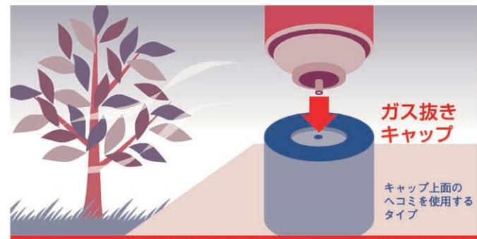
ガス抜きキャップの形状、使用方法は、製品によって異なります。
